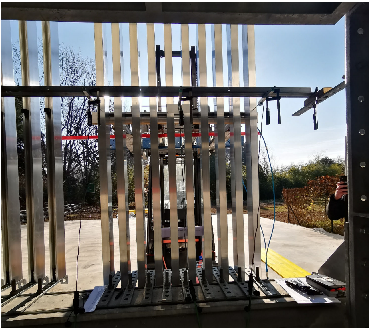
Foto 8. Campione 1126/24/IR sottoposto a prova e assetto sperimentale per l'applicazione dei carichi statici lineari
