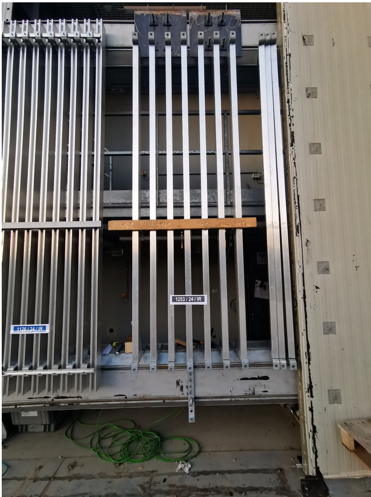
Foto 10. Campione 1253/24/IR sottoposto a prova e assetto sperimentale per l'applicazione dei carichi statici lineari
