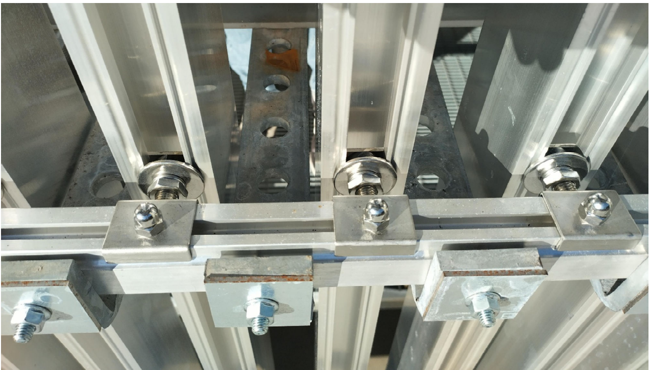
Foto 6. Foto 7. Campione 1126/24/IR: dettaglio del sistema di fissaggio
