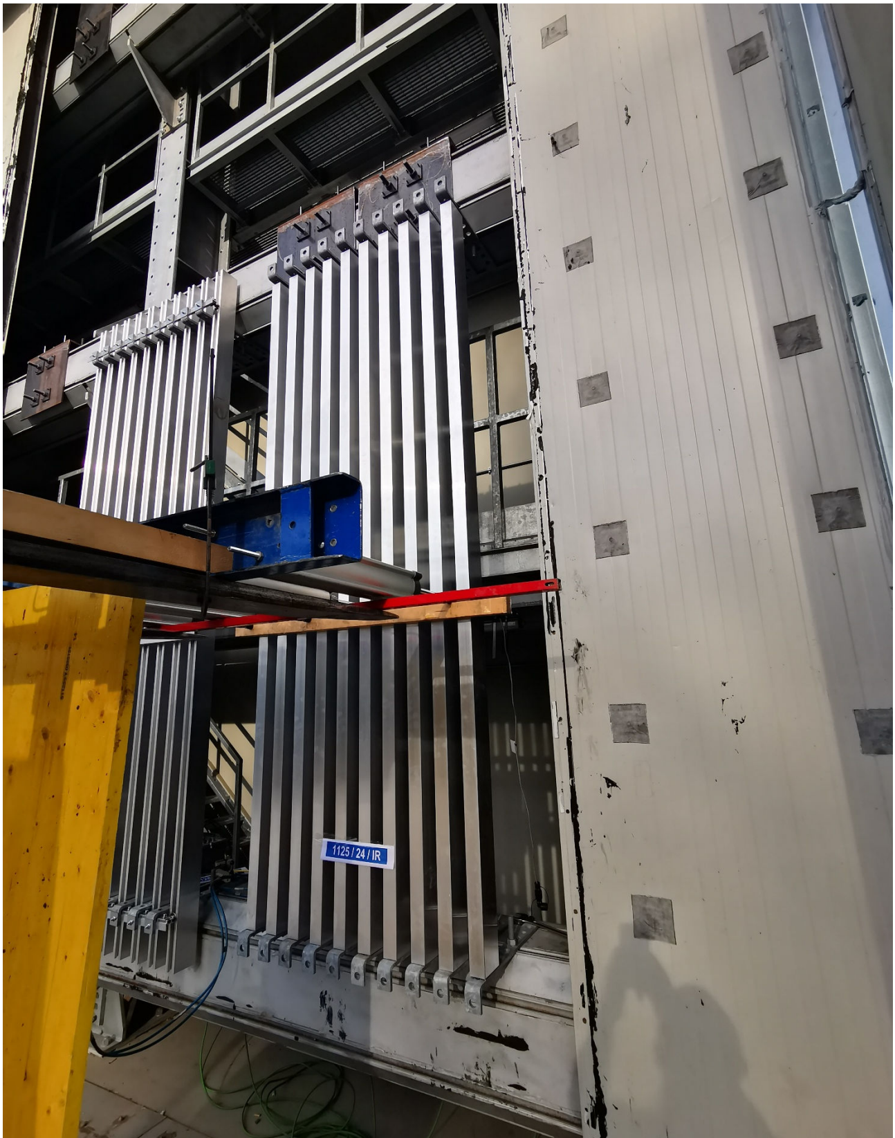
Foto 1. Campione 1125/24/IR sottoposto a prova e assetto sperimentale per l'applicazione dei carichi statici lineari
