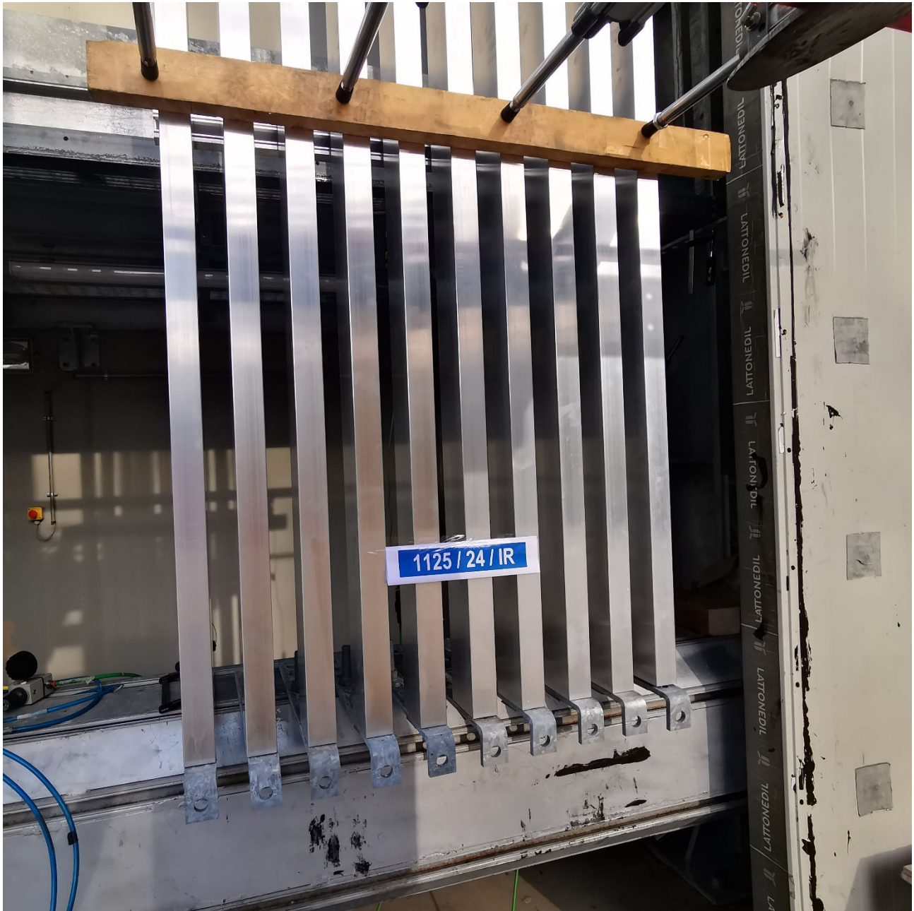
Foto 4. Campione 1125/24/IR sottoposto a prova e assetto sperimentale per l'applicazione dei carichi statici lineari
