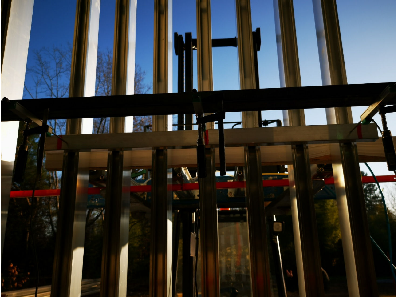
Foto 11. Campione 1253/24/IR sottoposto a prova e assetto sperimentale per l'applicazione dei carichi statici lineari
