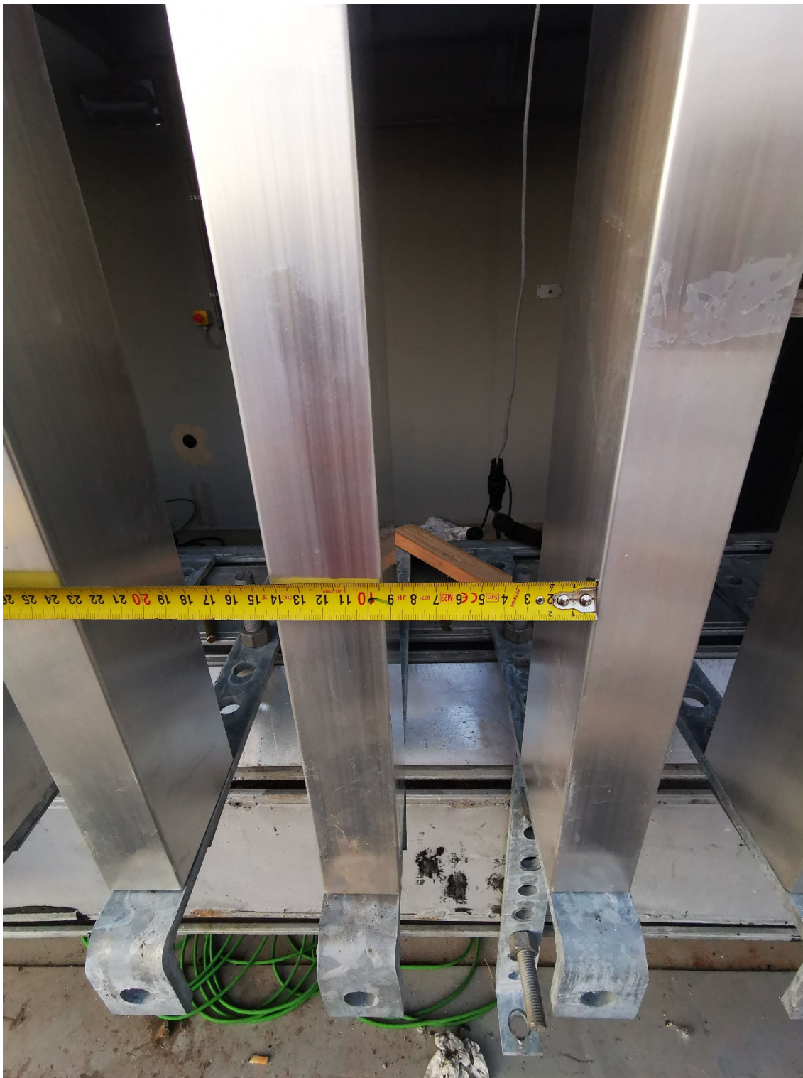
Foto 12. Campione 1253/24/IR: dettaglio del passo di fissaggio degli elementi
