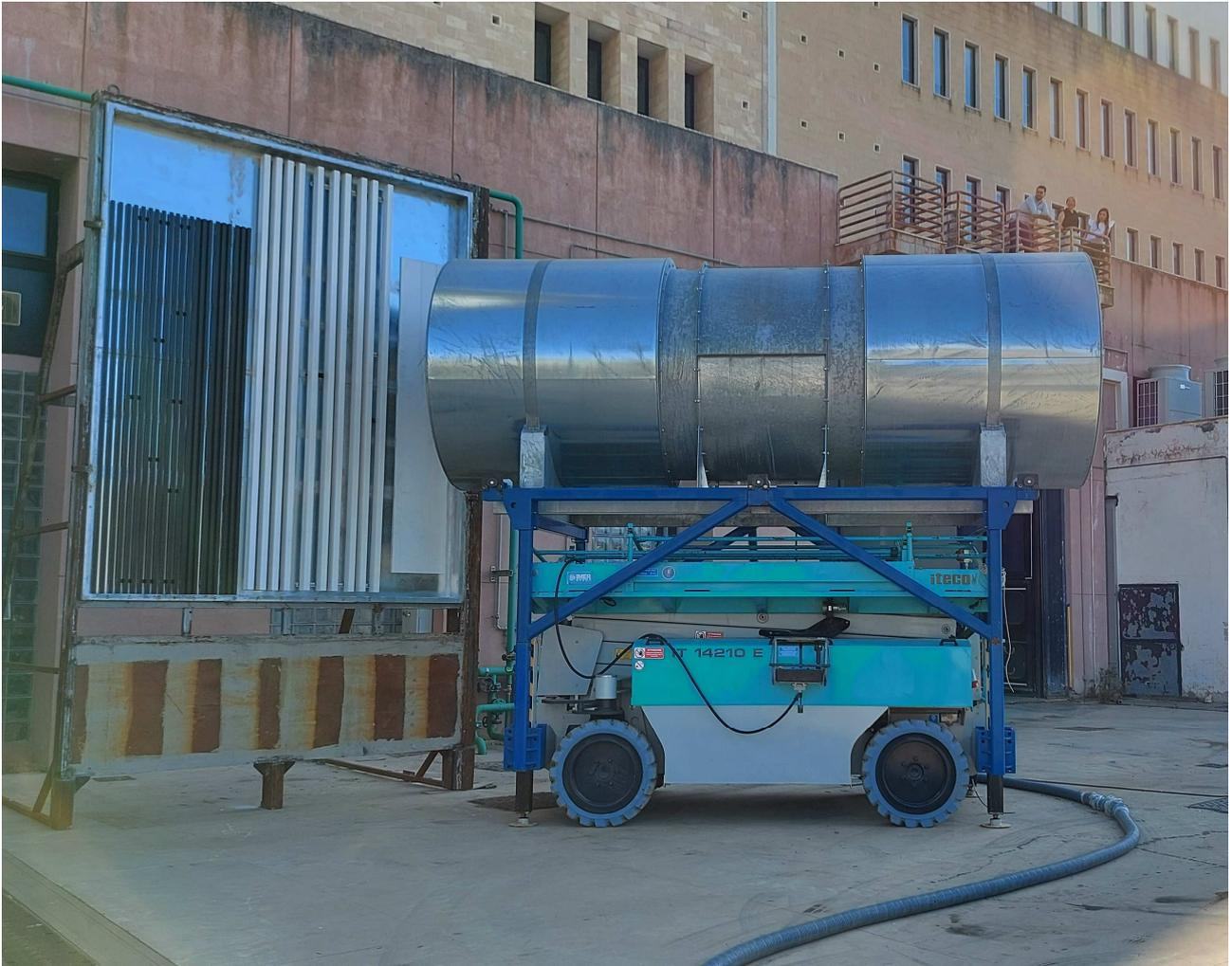
Foto 3. Campione sottoposto a prova di resistenza al carico del vento sotto pressioni dinamiche – flusso iclinato a 45°
