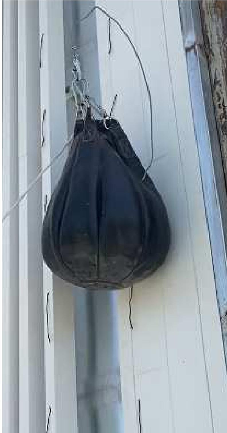
Foto 6. Campione sottoposto a prova di resistenza all'urto con corpo molle\_CLADDING 150
