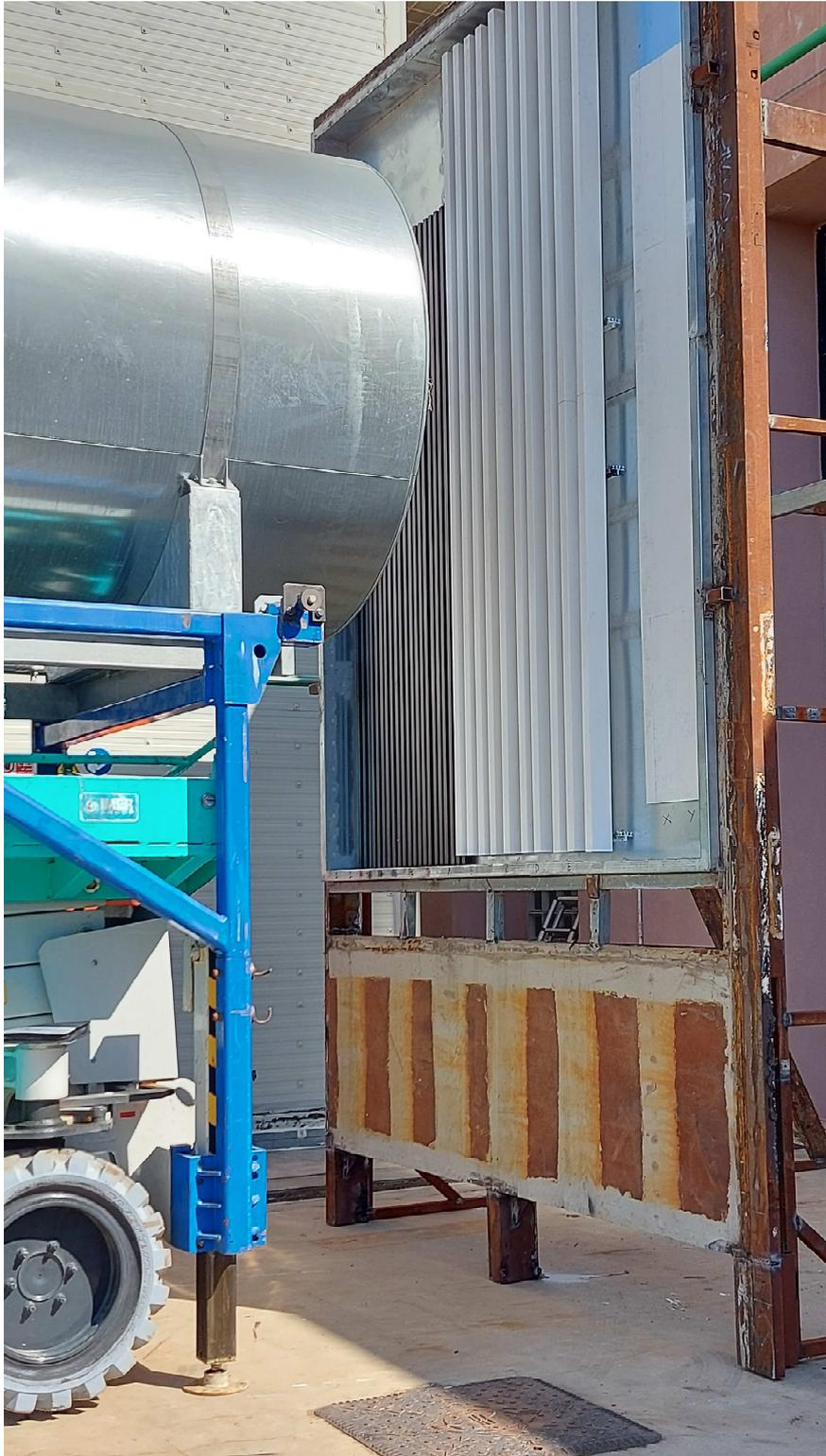
Foto 2. Campione sottoposto a prova di resistenza al carico del vento sotto pressioni dinamiche – flusso ortogonale
