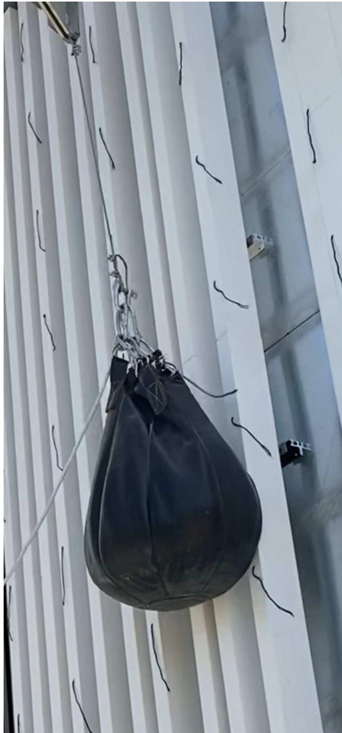
Foto 5. Campione sottoposto a prova di resistenza all'urto con corpo molle\_BATTENS 50
