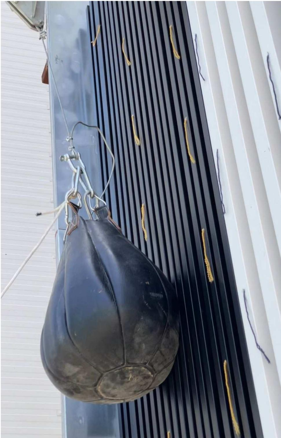
Foto 4. Campione sottoposto a prova di resistenza all'urto con corpo molle\_BATTENS 30
